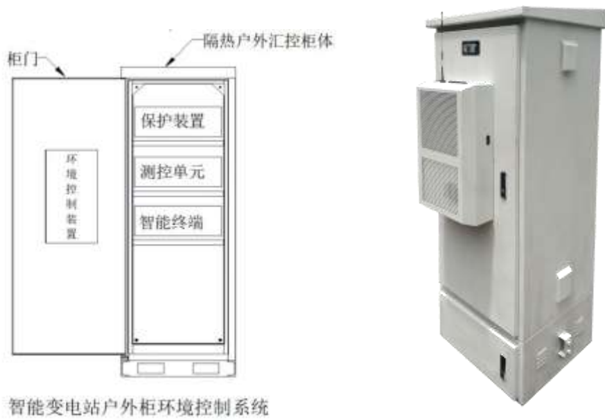
图A.1 智能变电站户外柜环境控制系统配置示意图
